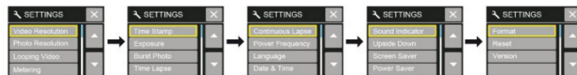
Appuyez sur le bouton **Shutter/Select** pour entrer dans le menu réglages. Appuyez sur le bouton **Power/Mode** pour parcourir les différentes options et appuyez sur le bouton **Shutter/Select** pour sélectionner l'option souhaitée. Pour revenir sur l'écran précédent ou sortir du menu réglages appuyez sur le bouton **Wi-Fi**.
