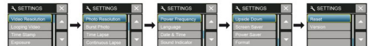
Pulse el botón de **Disparador/Seleccionar** para acceder al menú de ajustes. Pulse varias veces el botón de **Encendido/Modo** para cambiar entre las opciones y pulse el botón de **Disparador/Seleccionar** para elegir la opción que desee. Para volver a la pantalla anterior o salir del menú de ajustes, pulse el **botón de Wi-Fi**.
