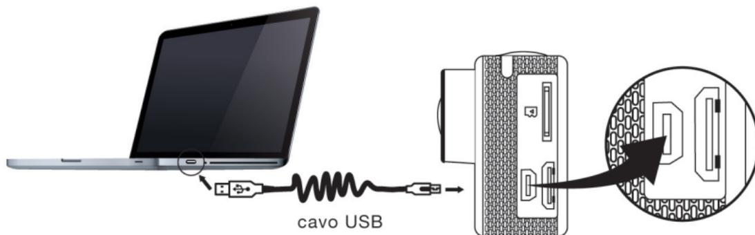
Connettere la camera alla porta USB del computer per ricaricare. L' indicatore di ricarica sarà rosso, e si spengerà una volta ricaricato il dispositivo. Solitamente la ricarica impiega 3/5 ore.
